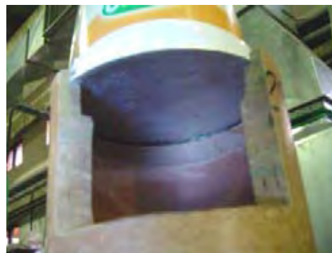
Fuente: Grupo de Estudio JICA Fig. 7.3.5-10 Vibración de la tapa de Al a frecuencias de 20 a 40 Hz
