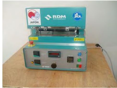
Fig. 7.3.3-8 Equipo de ensayo de resistencia de sellado
