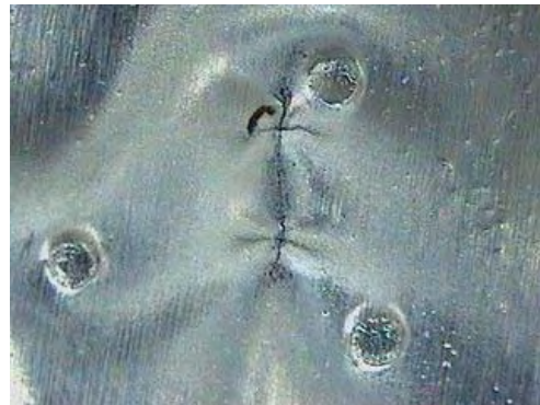
Fig. 7.3.5-16 Fisura en tapa de Al mejorado y 3 protuberancias
