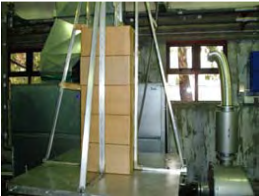
Fig. 7.3.5-3 Ensayo de Vibraciones de cajas apiladas en 5 capas (caja inferior)
