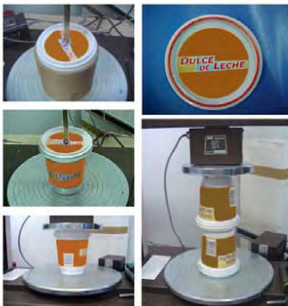
Fig. 7.3.5-13 Ensayos de compresion de tapas y potes
