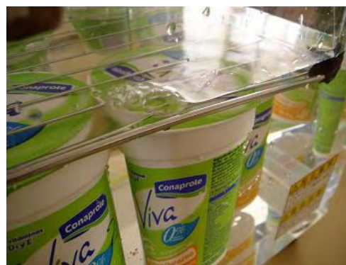
Fig. 7.3.4-6 Burbujas durante los Ensayos de hermeticidad
