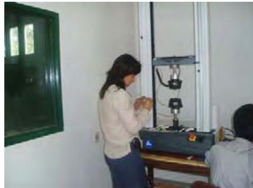
Equipo ensayo de traccion
