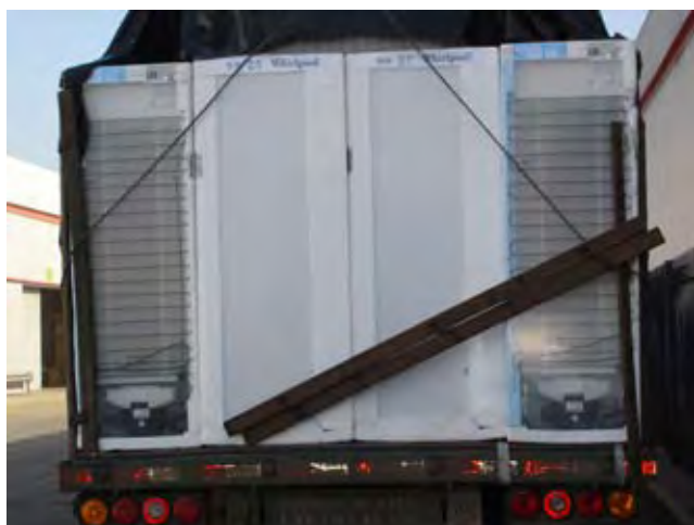
荷台後部のシートを外した状況： *製品上部コーナー角当て板が外れてEPSを痛めている。 *注意深くみると製品下部EPSの両角部が変形している。
