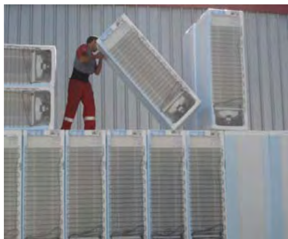
上部横積み製品の荷役作業： *製品・作業者とも危ない場面である。
