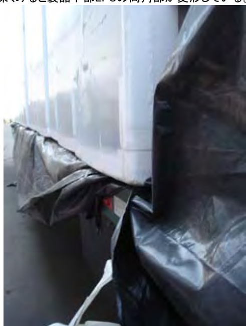
走行中の製品移動： *荷台から8cm移動してEPSが変形している。 Source: JICA 調査団
