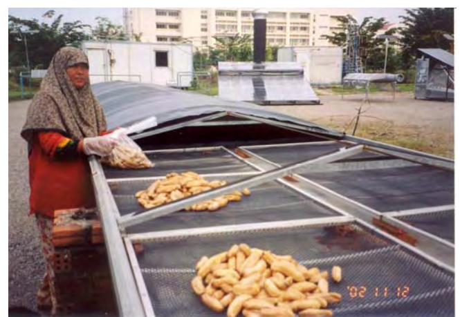
図5-5 太陽熱バナナ乾燥器(タイ SRET)
