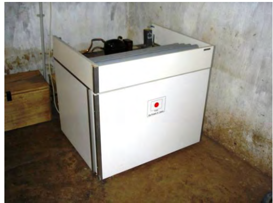
4) PV ワクチン冷蔵庫外観。WHO 認証品で保存容量は 38.7 リットル。内部は冷凍室と冷蔵室に分かれている。
