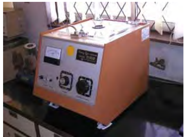
写真 4: 遠心分離器(トミー精工製、CD-50SR 型) ウイルス検査室の実験台上に設置されている。1980 年に我が国の技術協力により供与された。使用している。
