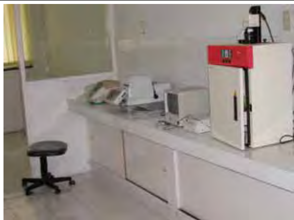
写真 6: PCR 装置(Eppendorf 製、BioRad 製)ほか滅菌室。写真の右側から紫外線イルミネーター (Uvitec 製)、2 台の PCR 装置。鳥インフルエンザ(AI)診断に 2006 年から使用している。
