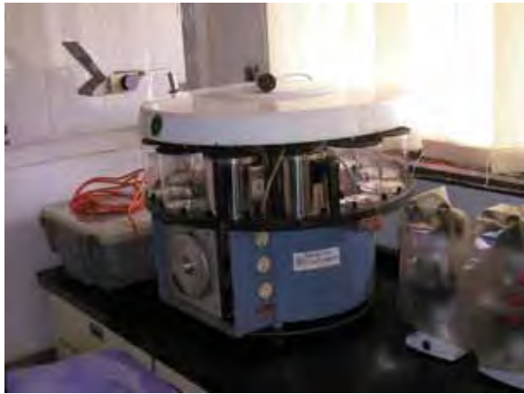
写真 1: 自動包埋装置(サクラ精機製、RH-12D 型) 病理検査室の実験台上に設置されている。1981 年に我が国の無償資金協力により整備された。使用している。
