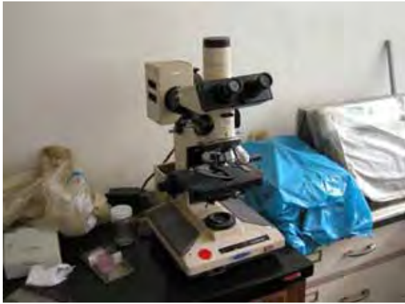
写真 1: 蛍光顕微鏡(オリンパス製、BH-2 型) 病理検査室の実験台上に設置されている。1980 年代に我が国の無償資金協力により整備されたが耐用年数を超えており使用の限界に達しつつあった。
