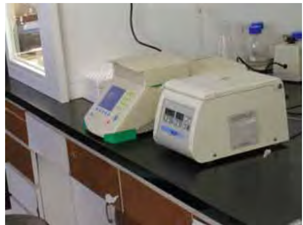
写真 6: PCR 装置(BioRad 製、iCycler 型) バイテク検査室の実験台上に設置されており、写真中央が該当。「イ」国農業省が 2005 年に配備した。
