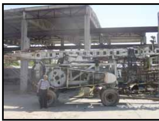
南部水文地質探査隊ワークショップの牽引式ケーブルツールリグ、1986年ソ連製、計画対象地域の玉石層を掘削するには能力が低すぎる
