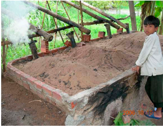
写真 16 ; プロジェクトで導入した製炭炉 (左端が製炭中)
