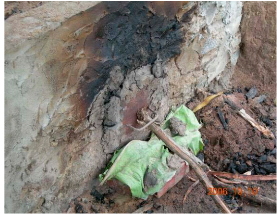
写真 17 ; 炉内の温度を下げないように釜口に目張りを をする工夫がされている。
