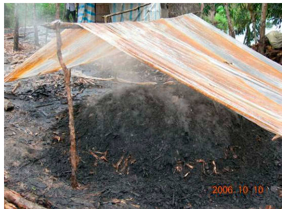
写真 15 ; 盛土しただけの伝統的製法 (伏せやき法)
