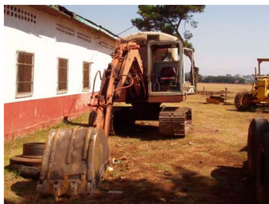
稼動可能なバックホーだが、かなり老朽化している
