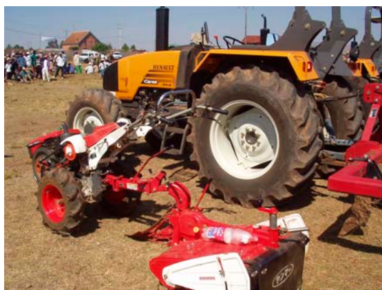
我が国より供与された耕耘機（ロータリーティラー付き）およびバキナカロチャ県が保有するトラクターの新車（CFAMA 保管）
