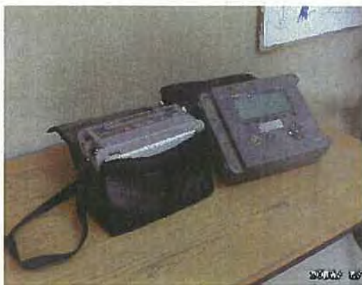
マンホール用ガス検知器（左）と ケーブル故障位置探索器（右）
