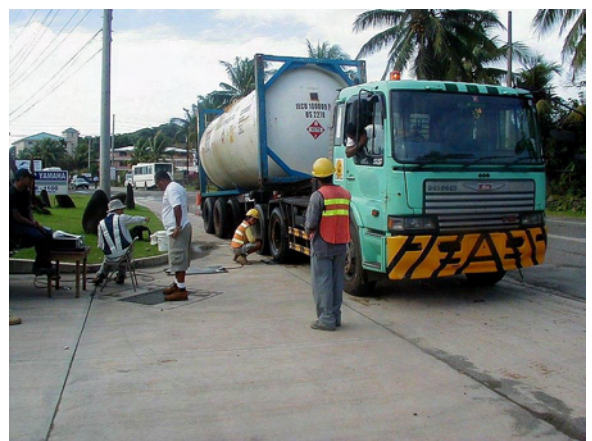
写真-12：軸重計（大型車両の軸重を計測） 軸重は標準の 10 トンを大幅に超えるものがあり、取締りが必要である。
