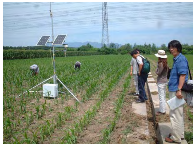
太陽電池利用によるフィールドサーバ (昌平総合研究基地)
