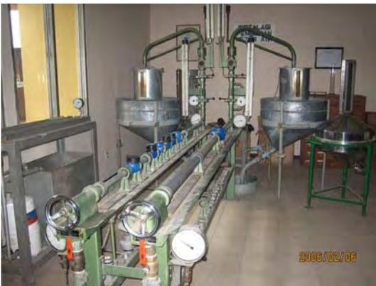
写真 5.7.2.3 水道メータ校正装置
