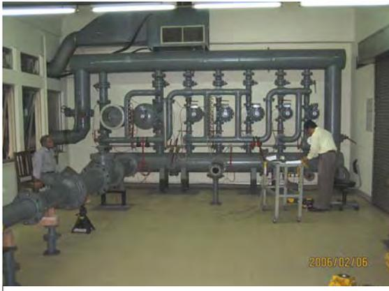
写真 5.7.2.1 ガスメータ校正装置
