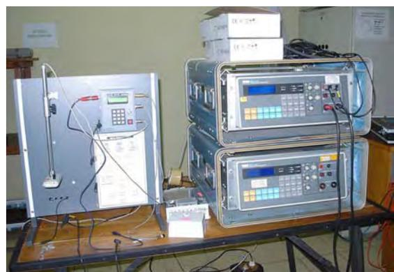
写真 5.7.2.4 電力量計用参照標準
