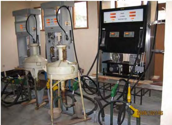
写真 5.7.2.5 ガソリン量機校正装置
