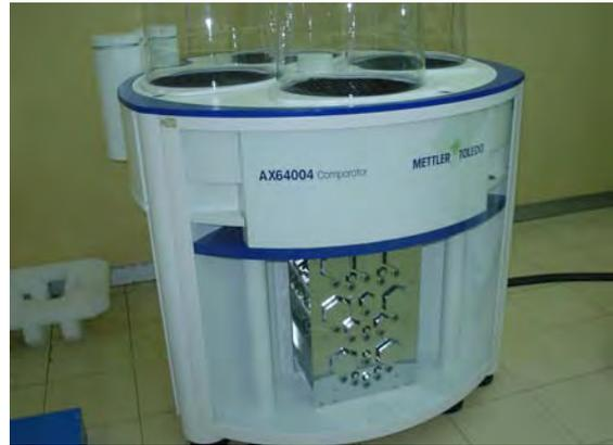
写真 5.7.2.2 コンパレータ (Mettler AX64004)
