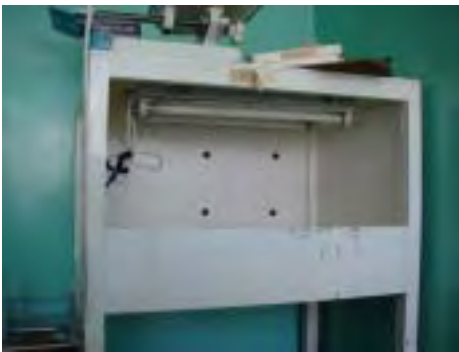
光線治療器 維持管理部により作られたもの。保温機能もカバーもない。
