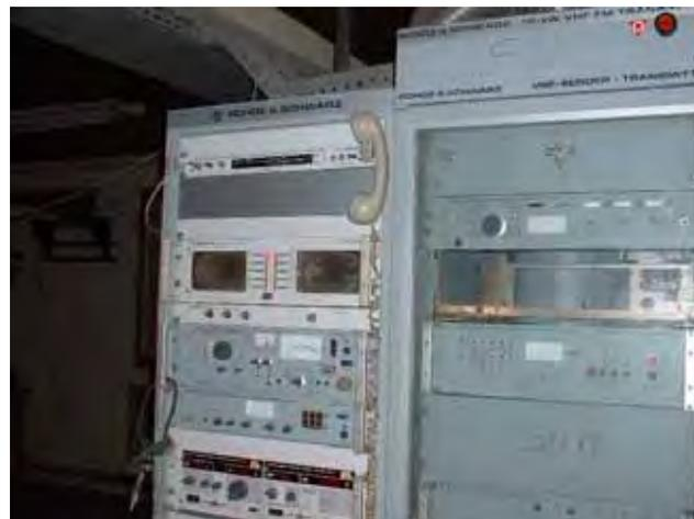
周辺環境と整合せず減力運転中の FM 送信機 (DB 社製: 写真左) と交換部品が入手できず運用停止している FM 送信機 (R&D 社製: 写真右)。ンガウンデレ同様、丁寧な保守を行っている。
