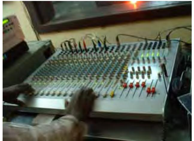
交換部品が入手できず動作が不安定な音声ミキサー (回路をバイパスして使用している)。
