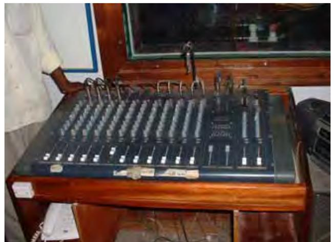
周囲のフレームの塗装をぬりかえたりして丁寧に運用しているが、交換部品が入手できず運用停止寸前の音声ミキサー。
