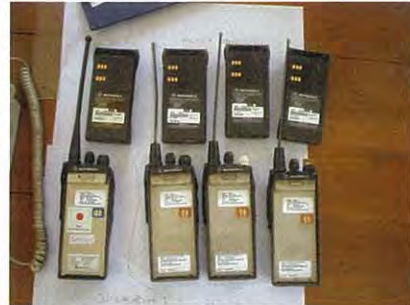
不良アンテナ及びバッテリー
