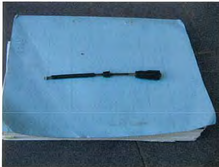
不良アンテナ(内部導体剥きだし)
