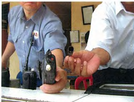
携帯無線機(アンテナ破損)
