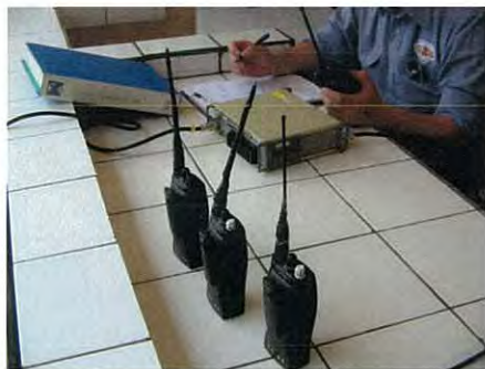
携帯機(アンテナ不良、つまみ不良)
