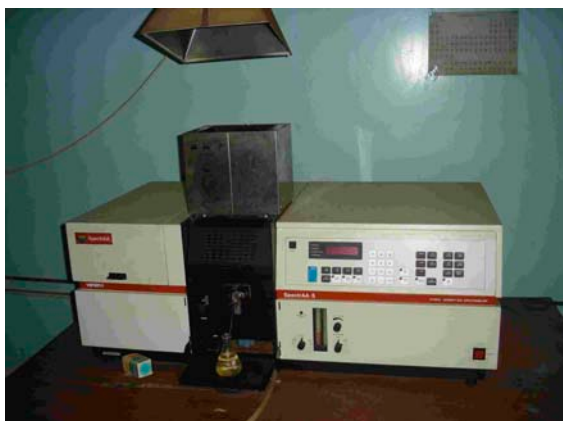
写真 10 原子吸光分析装置。ランプが切れており稼動していない。型式が古く部品の調達が困難であるとのこと。
