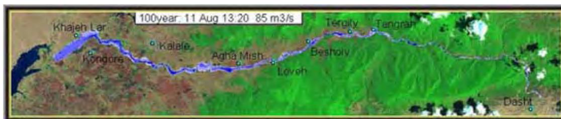
図 PII.24 マダルス川の100年確率洪水のシミュレーション結果
