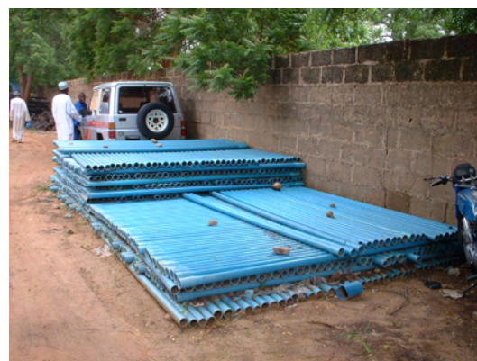
RUWASA 敷地に保管してあるハンドポンプ用揚水管 (UPVC)。φ2 インチ。
