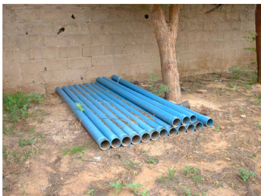
RUWASA の敷地に保管している井戸用ケーシングパイプ (UPVC)。φ4 インチ。
