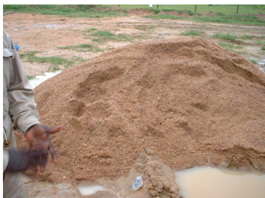
RUWASA が使用している井戸充填砂利。ホルノ州 Maiduguri の河床から採取している。掘削サイトに運搬後ふるいにかけて使用している。
