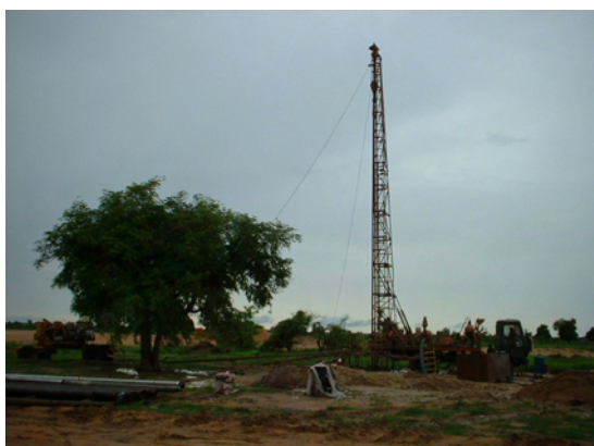
RUWASA 所有 Maz 社(ロシア製)車両搭載型掘削機。1993 年購入。ロシア製のためスペアパーツの入手が困難である。一旦故障すると修理に時間を要する。予備調査時も故障のため 2 週間ほど工程が遅れていた。
