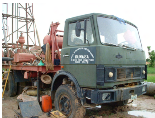
RUWASA 所有の Maz 社製車両搭載型掘削機。広い作業スペースが必要。
