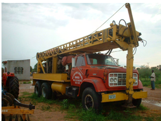
RUWASA 所有 Atlas Copco 社(スウェーデン製)の車両搭載型掘削機。1978 年購入。老朽化が激しく油圧式のためスペアパーツの入手が困難であることから工程管理が困難である。
