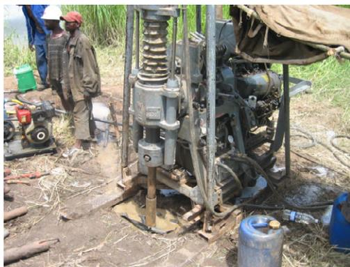
写真-3 ボーリング調査・掘削機械
