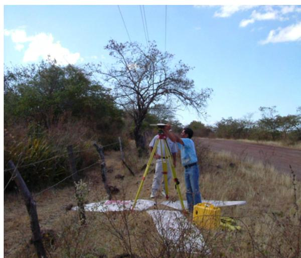
Foto 3-2 Instalación de Receptor GPS
