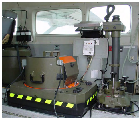
Foto 2-1 Cámara Aérea Leica RC 30 Foto 2-2 Aeronave en tierra
