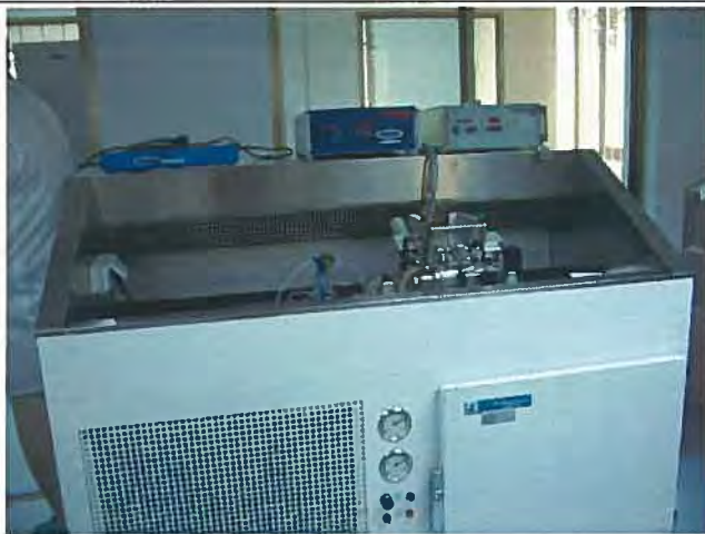
写真 7 : モンカダ人工授精センター 凍結精液製造のためのストロー充填機
