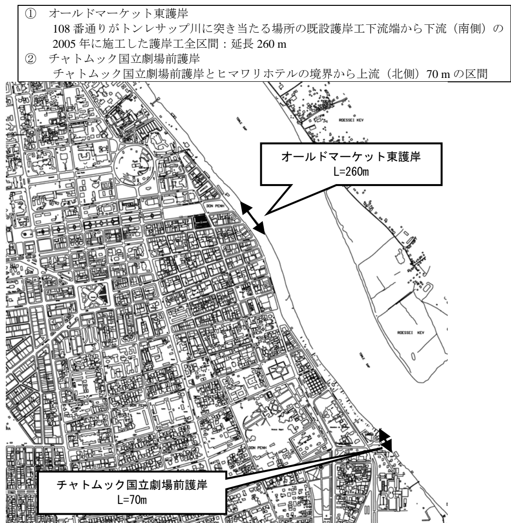
図 3.2.1 護岸改修の施工範囲
