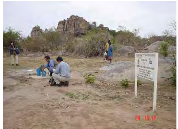
地下水位測定
