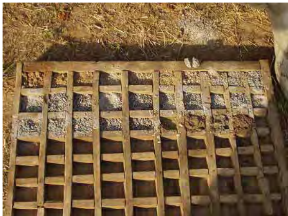
掘削 1 メートル毎に記録する地質サンプル
