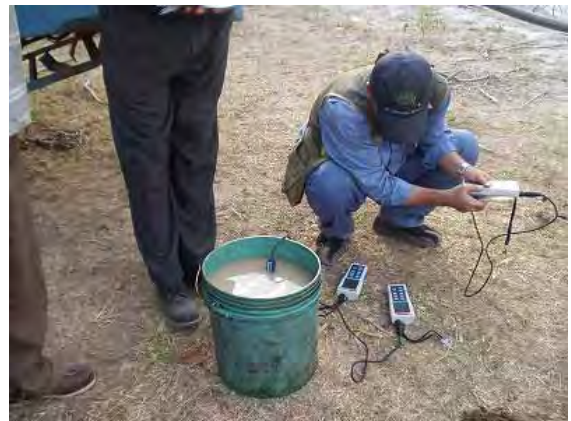
吹き上げられた地下水の現場簡易水質検査
