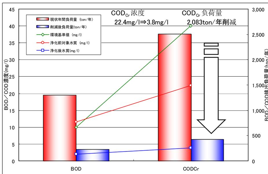
图 7.1.1 北沙河水质改善效果和污染物负荷的削减量
