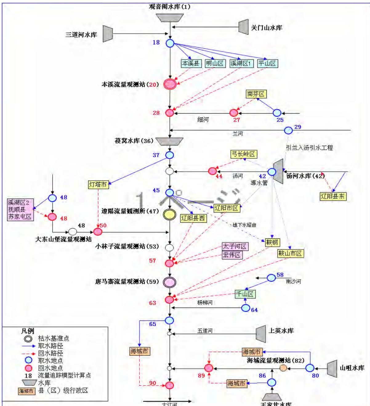
图 4.4.1 太子河流域水利模型的取水、排水系统图
