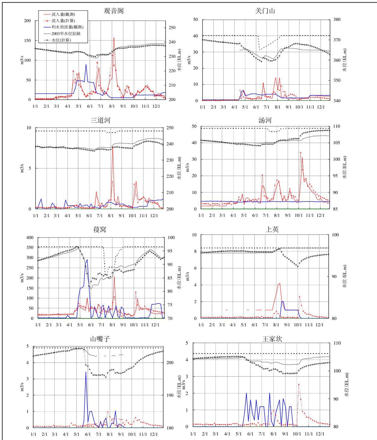
图 4.5.2 水库水库流入量、水位变化观测值和计算值的比较
