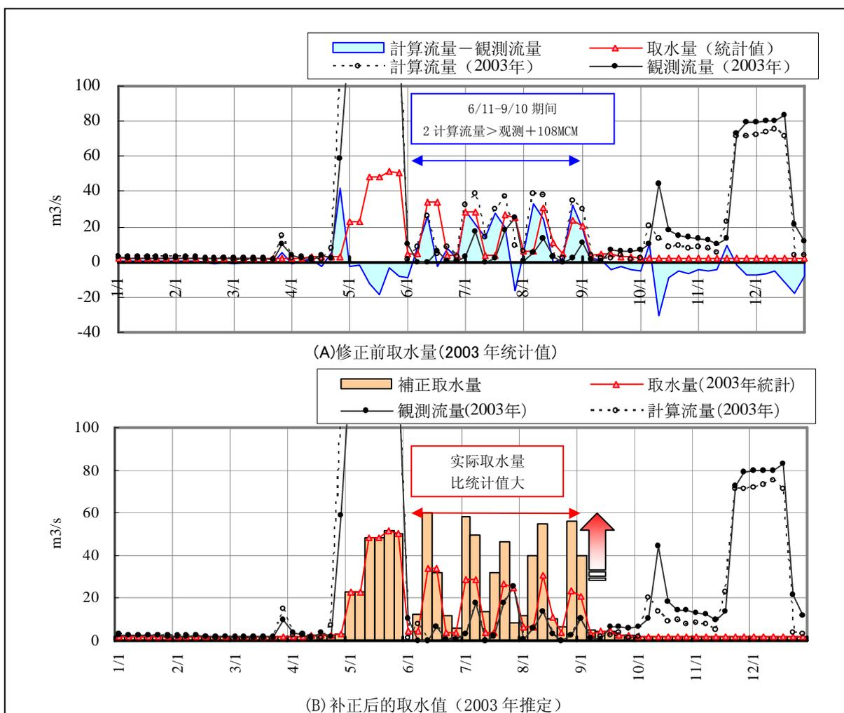
图 4.4.2 覆窝水库~辽阳流量观测站间取水量补正
