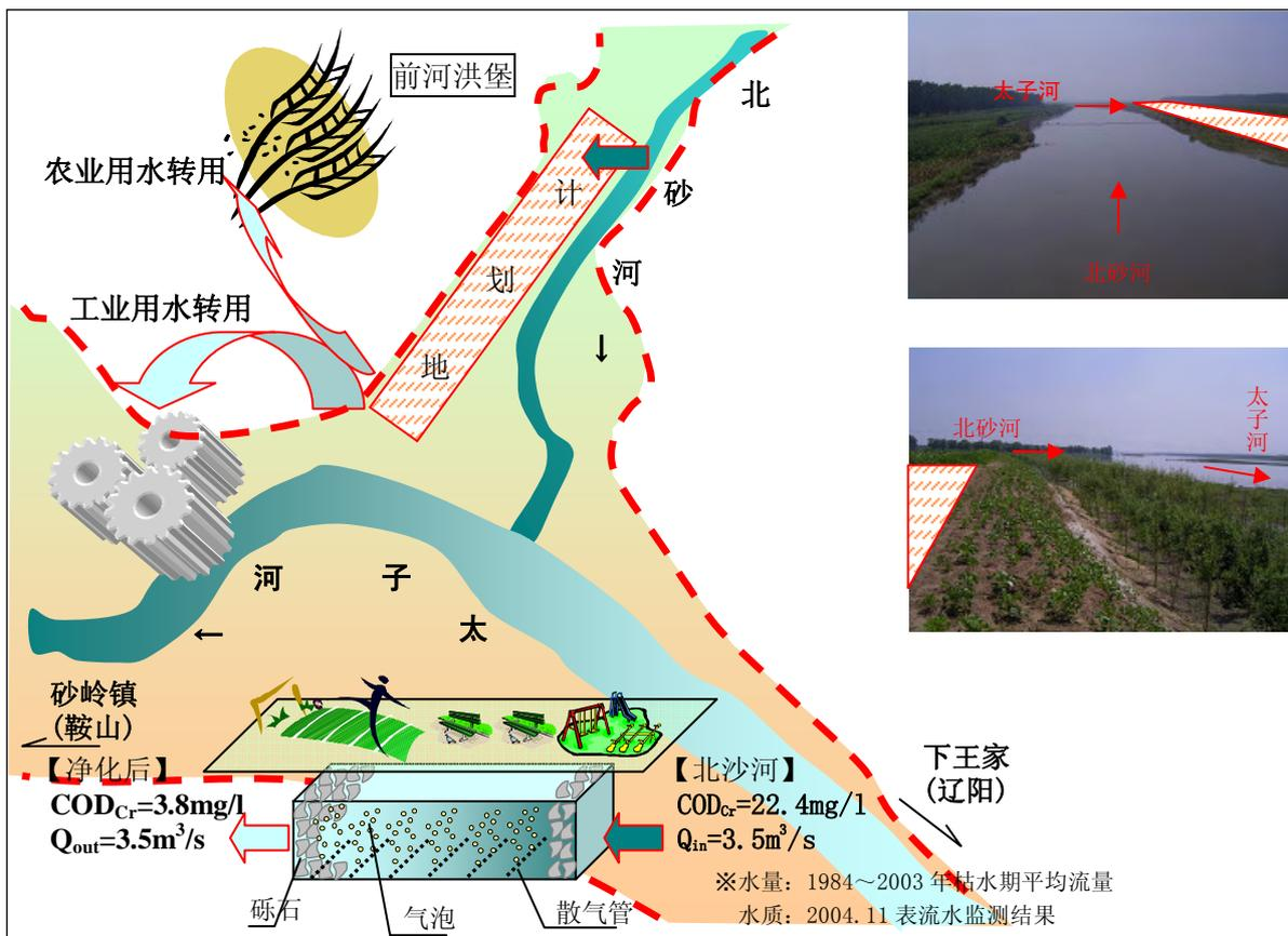
图 7.1.4 北沙河直接净化设施建设项目的概念图
