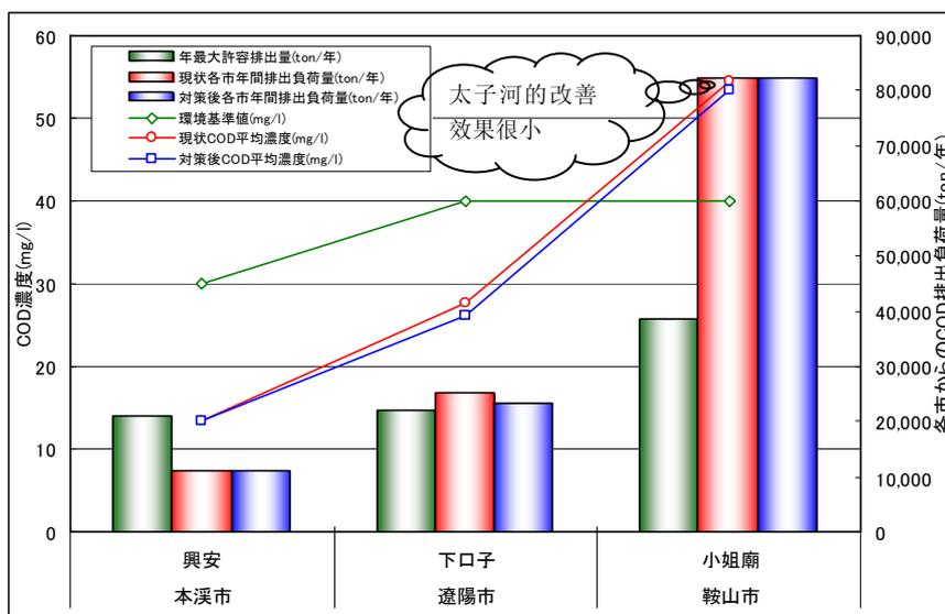
图 7.1.2 太子河水质改善效果和污染物负荷的削减量
