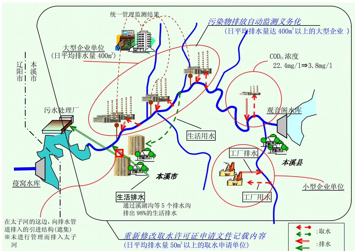
图 7.2.1 申请取水许可时的排水管理方法的重新修改项目概念图
