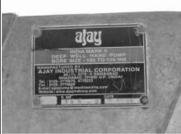
ポンプの製造業者銘板
