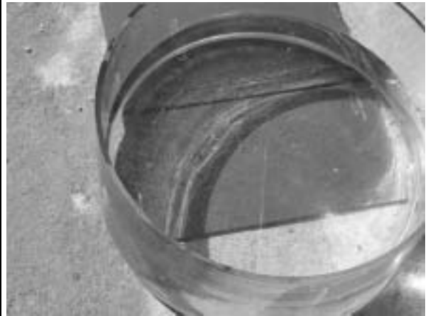
鉄分が沈殿している。
