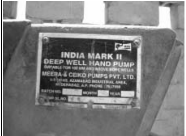
ポンプの製造業者銘板
