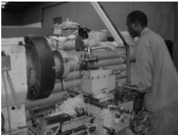
ケーシングパイプネジ加工
