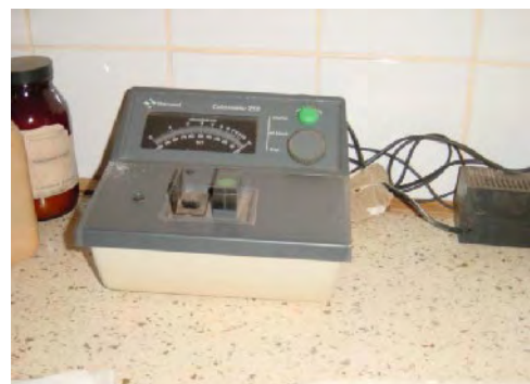
ナンドム病院 比色計：すべての検査を1台で実施している。
