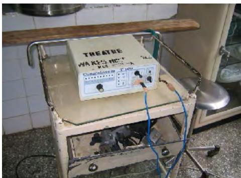
アッパーウエスト州病院 電気メス：15年経過しており電極が劣化しており 漏電の危険がある。
