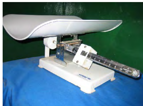
ナドリ郡 コジョクペレ保健所 新生児用体重計：つくりが粗雑で正確な計測ができない。
