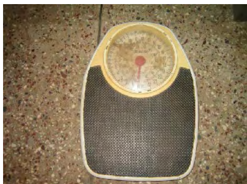
ローラ郡 バビリエ保健所 大人用体重計：老朽化し精度が落ちている。正確な計測ができていない。
