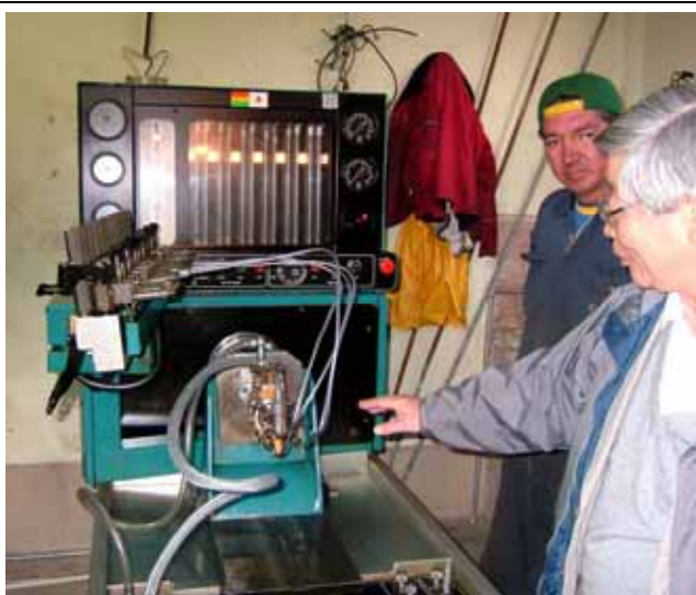
【ポトシ県】 日本の供与機材を使用するの燃料 噴射ポンプ調整作業
