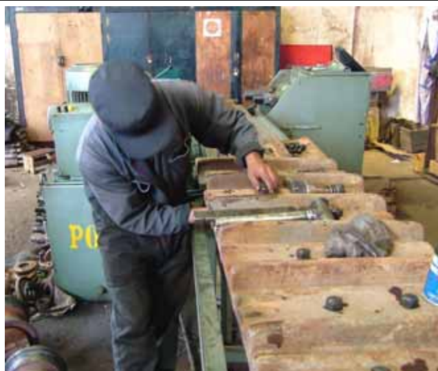
【ラパス県】 日本の供与機材を使用してのブルドーザ足回り整備作業
