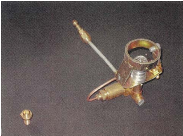
写真9 電気・ガス両用式冷凍冷蔵庫のパーツであるガスインジェクター。最も故障しやすい部品の1つだが、故障時の対応が不適切で、結果的に放置されるケースがある。
