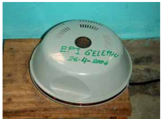
写真18 わが国が2005年に供与したものと同一インド製の電圧安定器であり、「ブ」国保健省の保健医療施設で多用されている。
