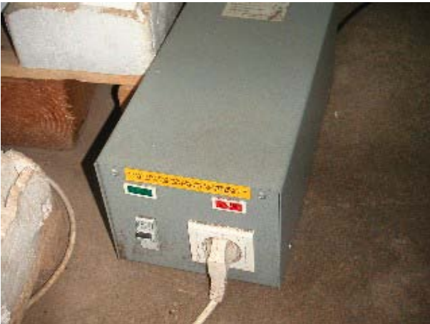
写真9 不安定な電圧供給による機材の故障を防ぐため、コールド機材と電圧安定器をセットで供与する必要がある。
