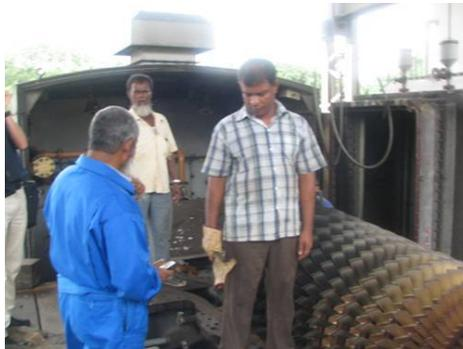
写真 3-4 ガスタービン分解作業の様子
