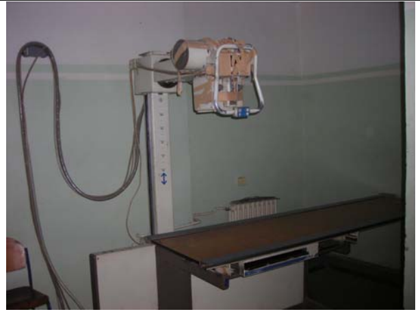
2. 老朽化し補修され使用されているが、適切な撮影が困難となっている一般撮影 X 線診断装置 (クリニカルセンター)
