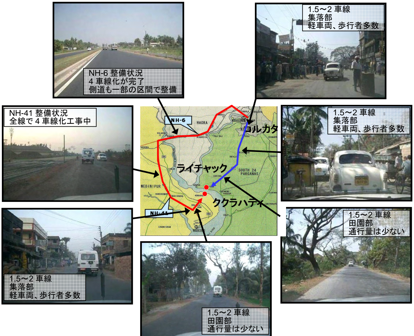
図 2-3 周辺道路の整備状況
