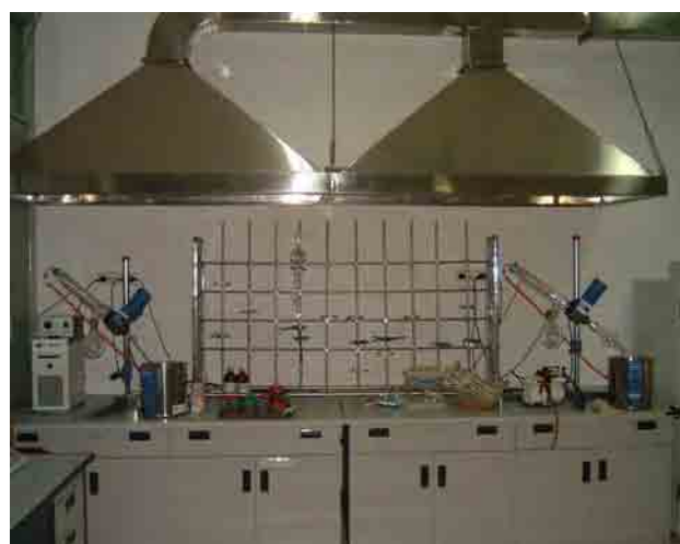
写真 4 : ロータリーエポレーター(左右) 有機溶媒を留去するのに用いる。(排気ダクトは整備中)
