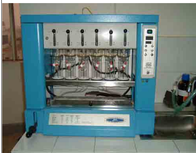
写真 3 : 脂肪抽出装置 安全かつ迅速に脂肪を抽出できる。
