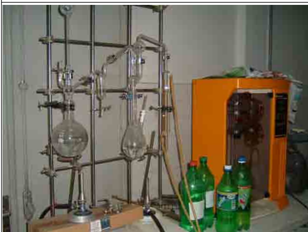
写真 11：窒素蒸留装置 (左右) 窒素定量に使用する。左はガラス器具を組み合わせたもの。右は半自動蒸留装置。
