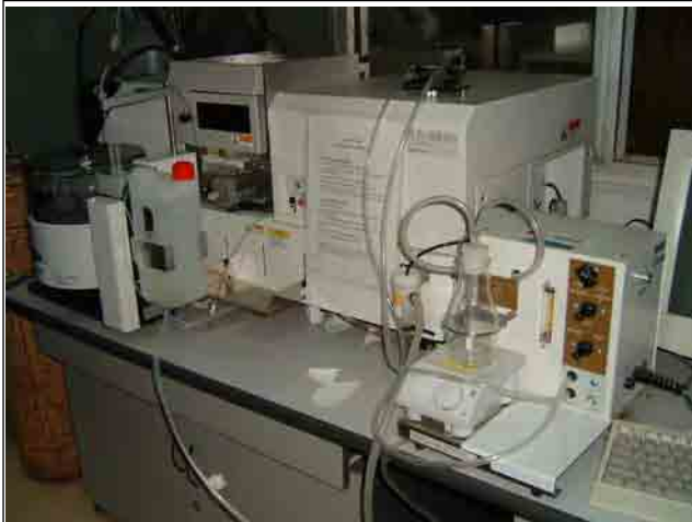
写真 9：原子吸光度計 無機元素分析に用いる。
