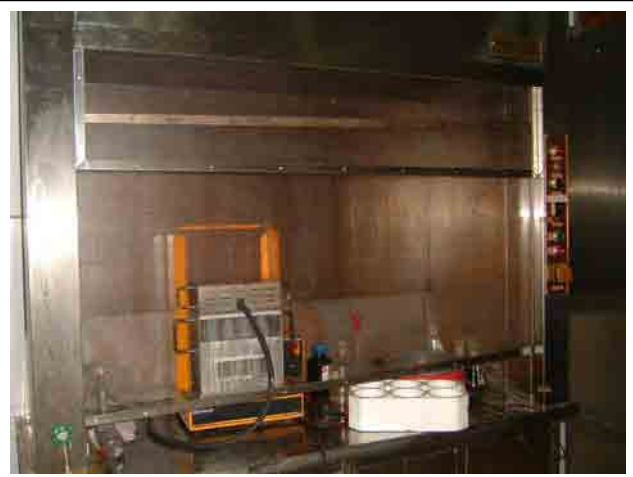
写真 10：電気式分解装置 ドラフトチャンバーの中に分解装置を置き、ケルダール分解を行っている。
