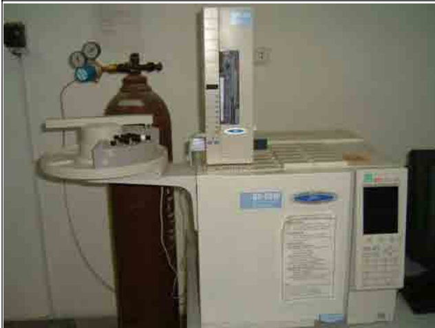
写真 7：ガスクロマトグラフ (GC) 気体試料のみならず気化し得る試料の分析に用いられる。
