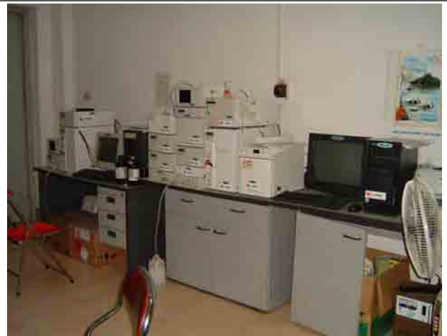
写真 8：高速液体クロマトグラフ (HPLC) 短時間で高性能な分離分析を行うことができる。
