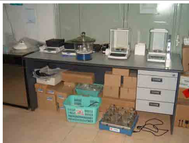
写真 6 : 自動ピュレット（左）、電子天びん（右） （左）滴定に用いる。（右）重量を正確（精密）に量る ためのもの。
