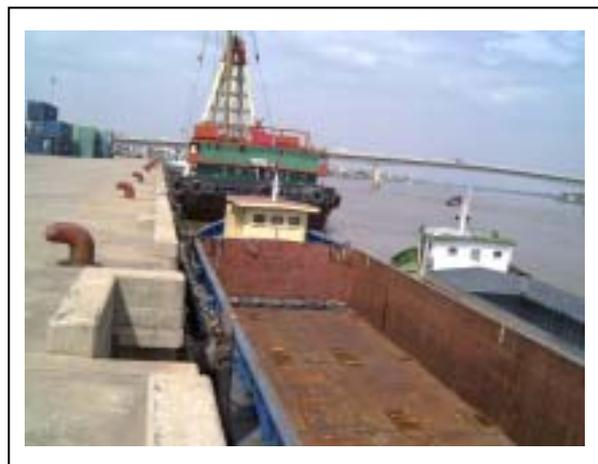
この河川コンテナ輸送のために、2001年に新たに建造した2隻のバージが投入された。これらバージの諸元は、船長49.98m、満載喫水3.6m、DWT1,883.6トン。積載量は72TEU(18.05t/box)、96TEU(12.01t/box)、120TEU(空コン)だ。潮の干満差を利用しなければならない河口部やベトナム領内
