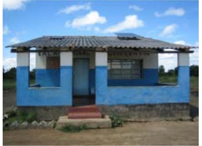
写真8) 南部州、Mazabuka郡、Kalama保健センター：Phase 1で機材整備。屋根に2つのソーラーパネルを設置（冷蔵庫用と無線機用）
