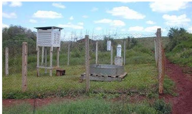
Estación 2: Observación de la precipitación, la temperatura, y la velocidad del viento
