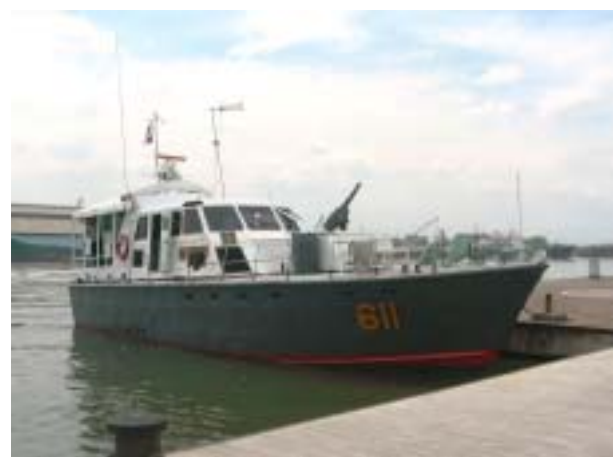
ジャカルタ基地 B クラス巡視艇 (ジャカルタ管轄のジャワ海の哨戒にあっている。最大船速 25 ノット)
