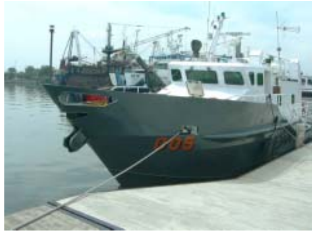
ジャカルタ基地 C-1 クラス巡視船 (高速艇であるが(最大船速 35 ノット)、小型(全長 17.2m)のため外洋には不適、)
