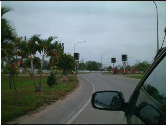
9) ラオス側の料金所を通過するとすぐに設置されているチェンジオーバー施設。信号付きの平面交差で右側通行から左側通行に車線を入れ替える。
