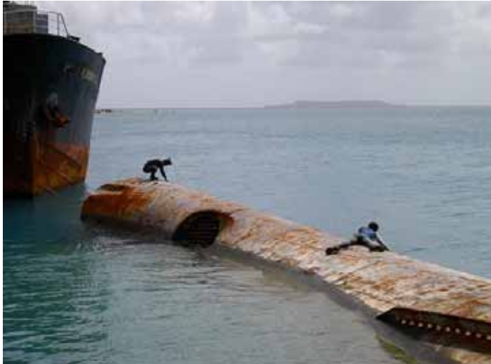
写真 - 10 ウエノ港 拡張B岸壁前面： 潜水士による沈船の潜水調査 船体キール・フレーム位置の測定。
