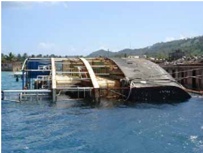
写真 - 11 ウエノ港 C岸壁前面： 沈船「MICRO DAWN」 沈没状況(横倒し90度)。
