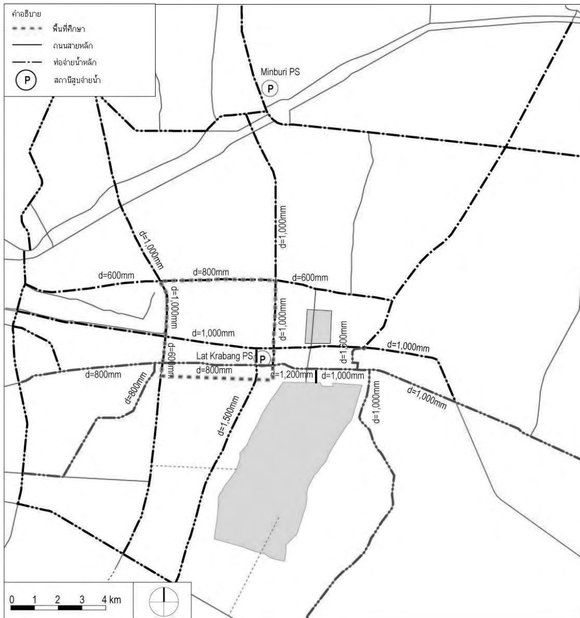
ภาพที่ 5.44 ระบบจ่ายน้ำประปาหลักในปัจจุบัน
