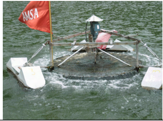
写真8 アマティトラン湖には AMSA により曝気装置が設置され湖水に酸素を供給している。
