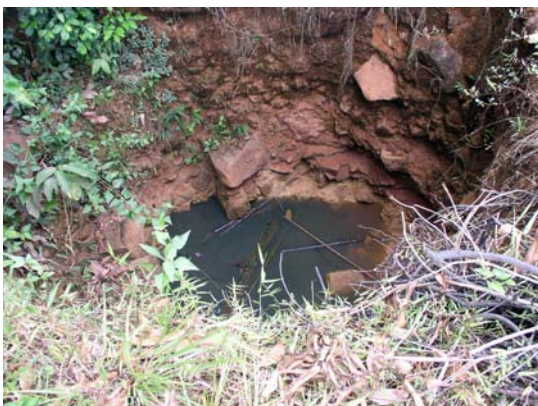
テストピット（地質調査）
