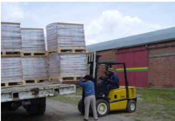
写真 9. 既存機材の現況： 中央センターのフォークリフト。12年を経過。医薬品保管庫には適さないガソリン駆動式のため、倉庫内の空気を汚染させている。
