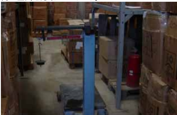
写真 11. 既存機材の現況： 中央センターのはかり。15年以上を経過。台座が小さくパレットの計量ができない。手で箱毎に計測するため、作業に時間がかかる。
