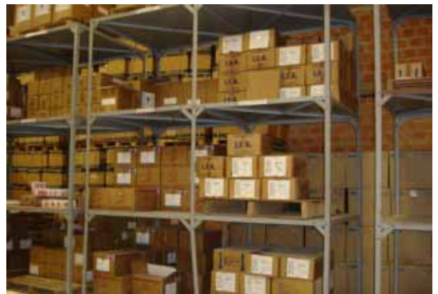
写真 10. 既存機材の現況： 中央センターのパレットラック。15年以上を経過。強度不足により危険な状態であり、十分な量の保管ができない。
