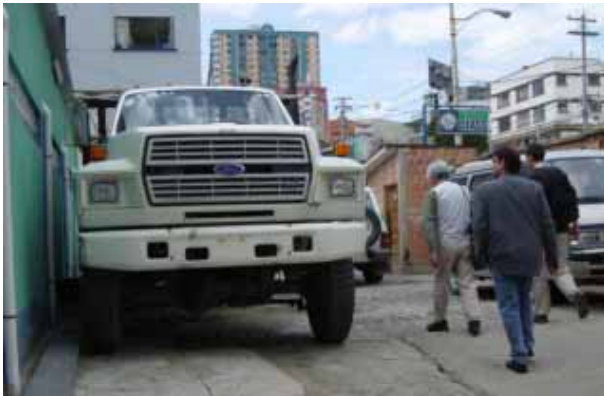
写真 7. 既存機材の現況： 中央センターの中型トラック。19年を経過。オイル漏れやエンジン不調などの修理を繰り返しており、計画的な配送ができない。
