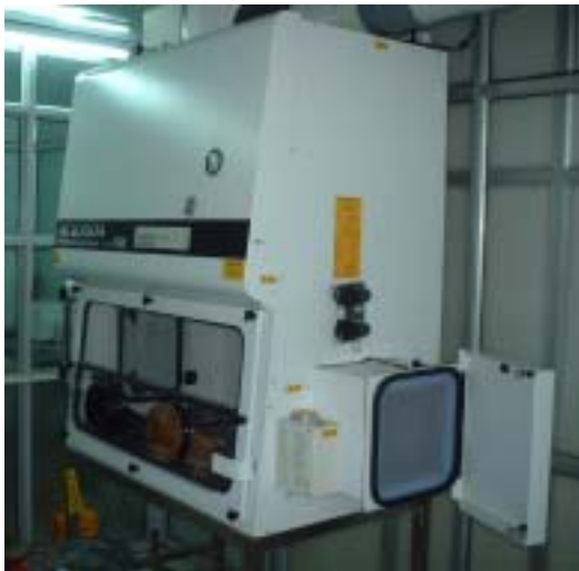
安全キャビネット(クラス II) (正常に稼動している)
