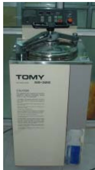
縦型高圧蒸気滅菌器 (正常に稼動している)
