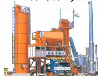
アスファルトプラント
